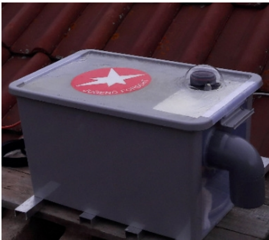
Abb. 1 Erster Prototyp der Kamerastation auf einem Hausdach in Dotternhausen im Zollernalbkreis
